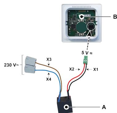
A. Fonte de alimentação permanente (230 VAC/5 VDC)
