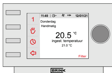
Display Brink eBus klokthermostaat
